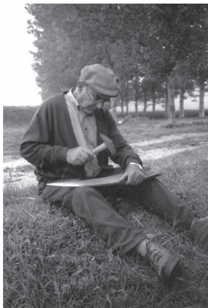
Feina de picar la dalla apriant el tall amb el martell picant sobre l'encluseta plantada a terra. Món Rural (UVic) Autor: Jacint Torrents.
