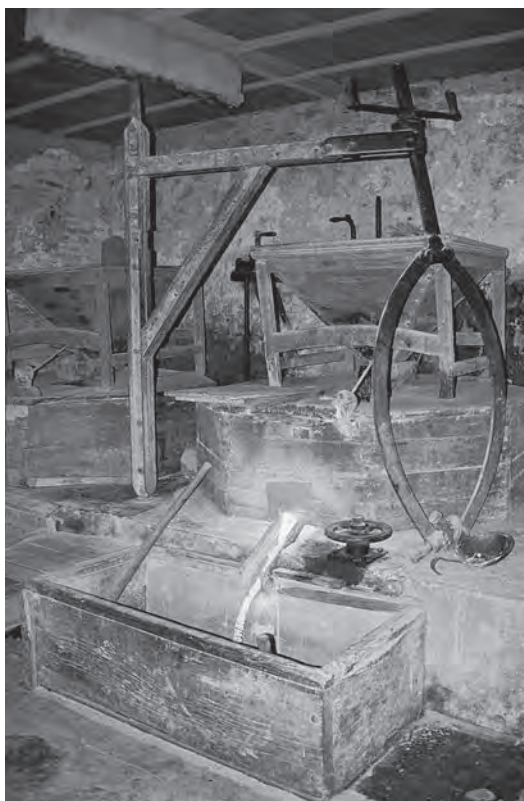
Interior del molí de Baix de Gaserans. Exemple de molí fariner en funcionament (Sant Feliu de Buixalleu). Foto IPEC
